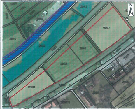
Lageplan (unmaßstäblich), rote Markierung = geplantes Gewerbegebiet, grüne Schraffur = regionaler Grünzug, blaue Fläche = Überschwemmungsgebiet HQ 100 , Illa = FFH-Gebiet, blaue Linie = Klingengraben
